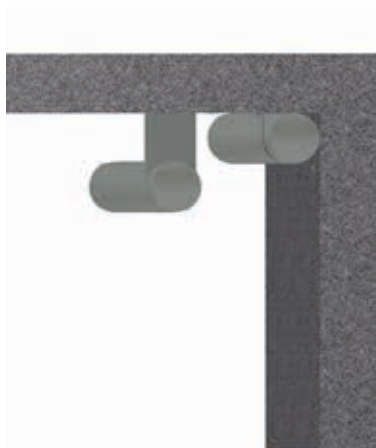
Montering av ventiler (don) kan ske med fästram eller direkt i röret.
